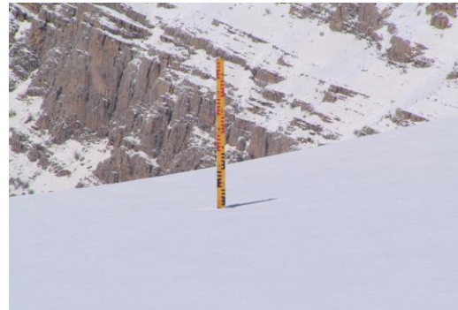
شکل ۲- اشل نصب شده در جایگاه‌های برف‌سنجی
