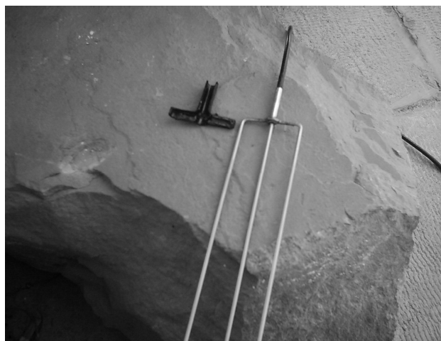
شکل ۳- نمایی از قطعات حس‌گر تدفینی، قطعه نگه‌دارنده شیوه اتصال میله‌ها با یکدیگر و کابل مربوطه
