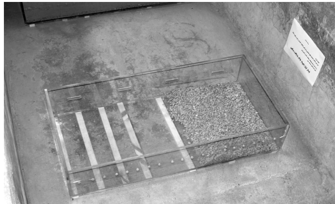
شکل ۱- استفاده از لایه نازک گراول در کف ظرف به‌منظور ایجاد محیط اشباع، سوراخ‌های تعبیه شده در کف و دو طرف جدار ظرف به‌منظور اشباع نمونه‌های خاک از پایین، قرار دادن حس‌گرها و نمونه‌برداری وزنی خاک
