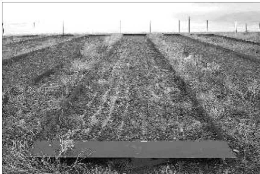
شکل ۳- کرت مالچ پاشی شده در طبقه شیب ۲۰-۱۰ درصد
