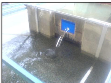
شکل ۱- فلوم آزمایشگاهی و حوضچه پایین دست روزنه
