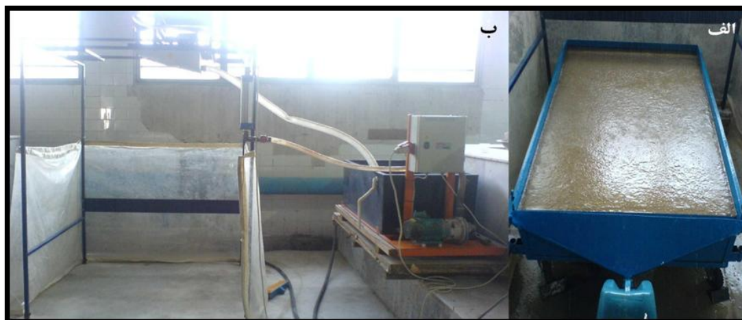
شکل ۱- نمایی از کرت آزمایشی (الف) و شبیه‌ساز باران (ب)
