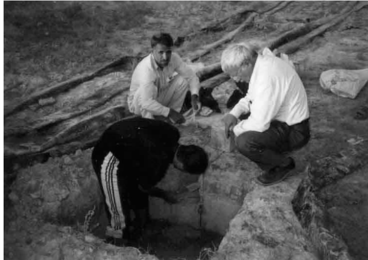
شکل ۳- نیم‌رخ خاک و نحوه تهیه نمونه‌های خاک
