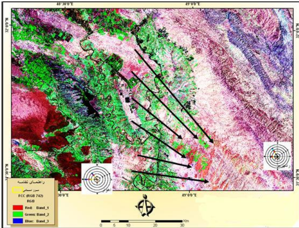
شکل ۷- تصویر حاصل از افزایش تابین و روشنایی ترکیب کاذب رنگی RGB742 و تلفیق آن با گل‌باد ایستگاه‌های سینوپتیک اهواز و رامهرمز در محدوده تپه‌های ماسه‌ای جنوب شرق خوزستان (پیکان‌های روی تصویر جهت حمل رسوبات و مناطق برداشت را نشان می‌دهند که عمود بر قله برخان‌ها و تپه‌های عرضی می‌باشد)
