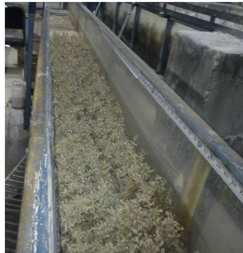
شکل ۲- نحوه چیدمان پوشش گیاهی در فلوم با تراکم ۵۰ درصد
