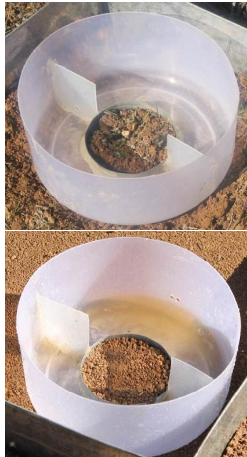
شکل ۲- فنجان پاشمان مورد استفاده در پژوهش بر روی خاک در دو حالت طبیعی (راست) و آماده‌سازی شده (چپ)
