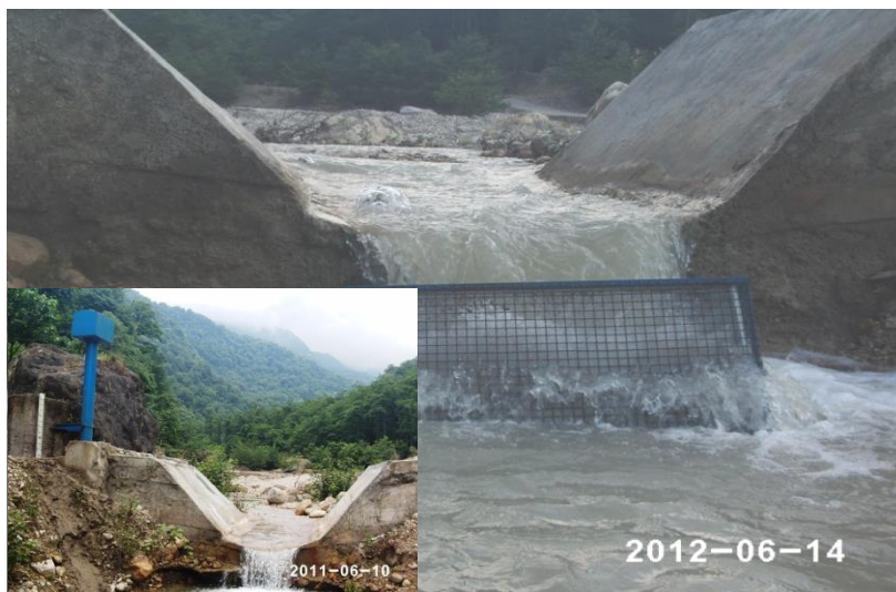
شکل ۲- نحوه استقرار نمونه‌بردار در پایین دست فلوم در حوزه آبخیز آموزشی-پژوهشی دانشگاه تربیت مدرس
