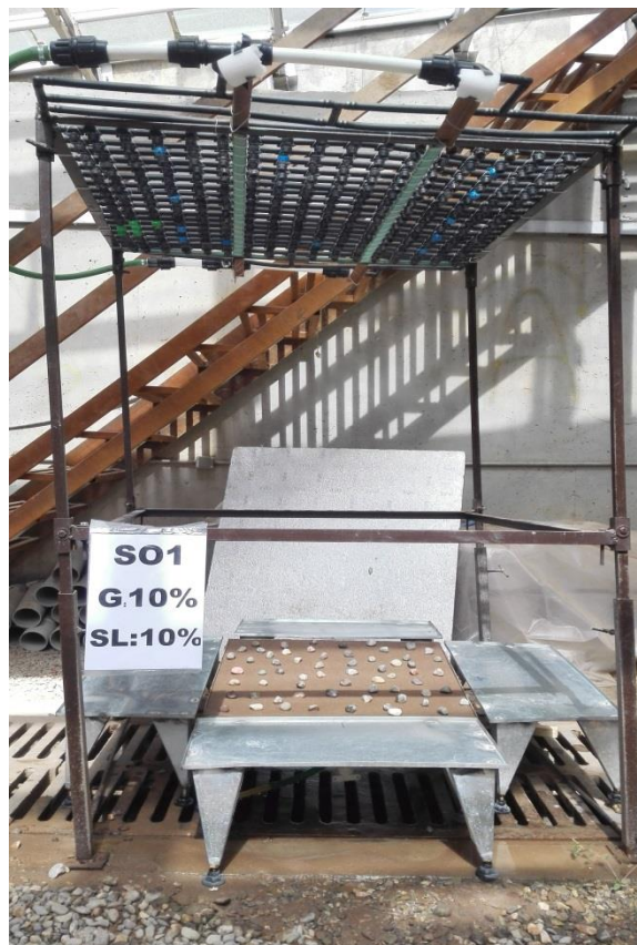
شکل ۱- نمایی از دستگاه شبیه‌ساز باران و تشتک مورد استفاده در آزمایش‌های شبیه‌سازی فرسایش پاشمانی و بین‌شیاری
