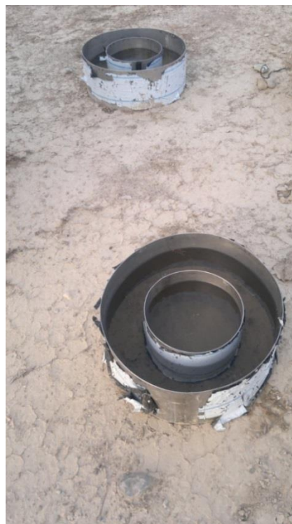
شکل ۶- اندازه‌گیری نفوذپذیری با استفاده از استوانه مضاعف
