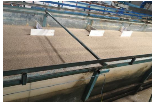
شکل ۳- آبشکن‌های مورد استفاده در یکی از ترکیب‌ها
