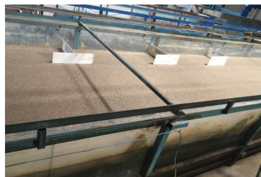
شکل ۳- آبشکن‌های مورد استفاده در یکی از ترکیب‌ها
