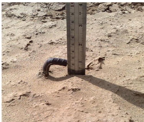
شکل ۷- اندازه‌گیری ارتفاع بادبردگی خاک از زیر شاخص‌های فلزی در اراضی مختلف منطقه مورد بررسی
