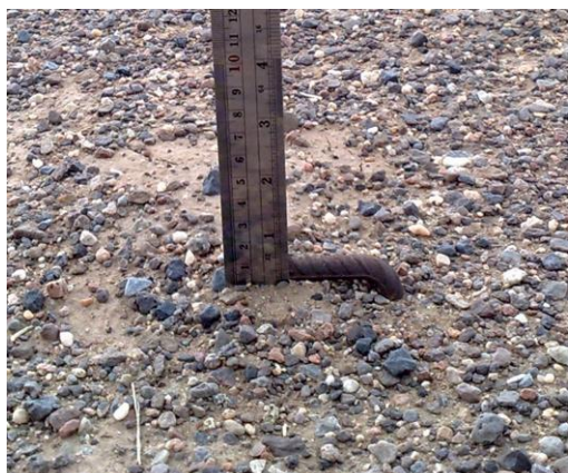
شکل ۷- اندازه‌گیری ارتفاع بادبردگی خاک از زیر شاخص‌های فلزی در اراضی مختلف منطقه مورد بررسی
