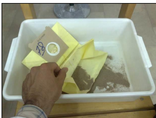
شکل ۸- ذخیره ذرات فرسایش‌پذیر در درون فیلتر کیسه‌ای مخزن دستگاه
