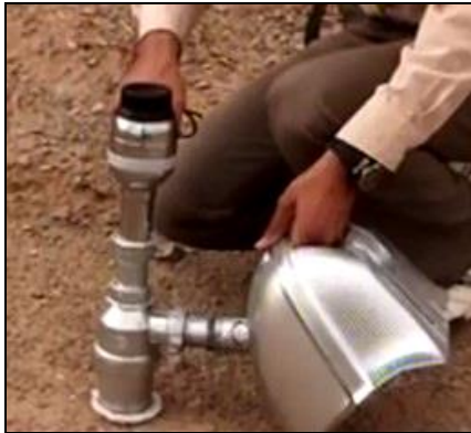
شکل ۱- نمونه اولیه دستگاه اندازه‌گیری نسبی حساسیت خاک به فرسایش بادی
