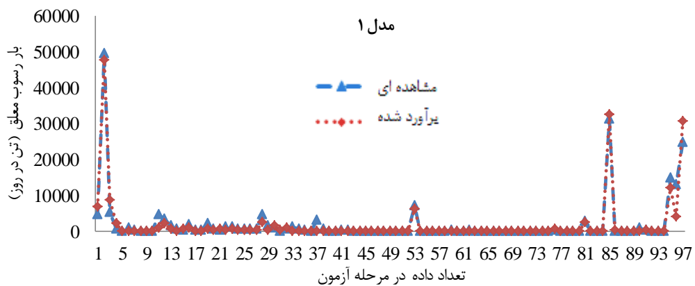
شکل ۶- نمودار روند مدل مناسب حاصل از برآورد بار رسوب معلق روزانه با مدل شبکه عصبی مصنوعی با توابع فعال‌سازی تانژانت سیگموئید در مقابل مقادیر مشاهداتی
