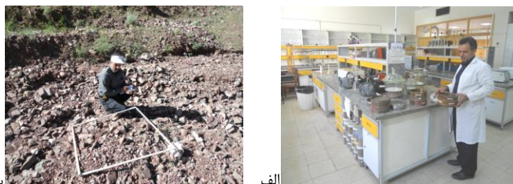
شکل ۴- الف) عملیات دانه‌بندی رسوبات جریان‌های سیلابی در آزمایشگاه و ب) در صحرا
