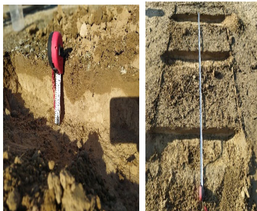
شکل ۶- اندازه‌گیری عمق جبهه رطوبتی Fig. 6. The moisture front depth measurement
