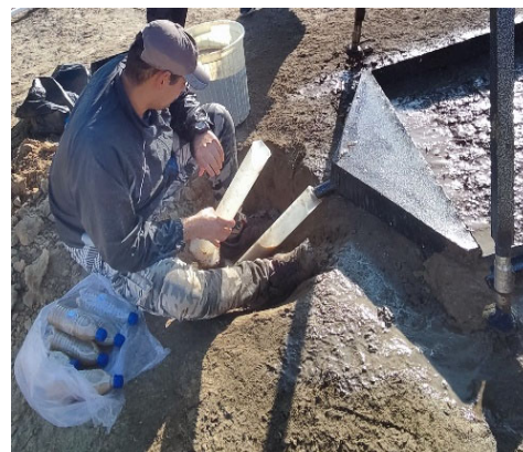
شکل ۵- نمونه‌برداری و جمع‌آوری رواناب توسط استوانه مدرج Fig. 5. Runoff sampling and collection using a graduated cylinder
