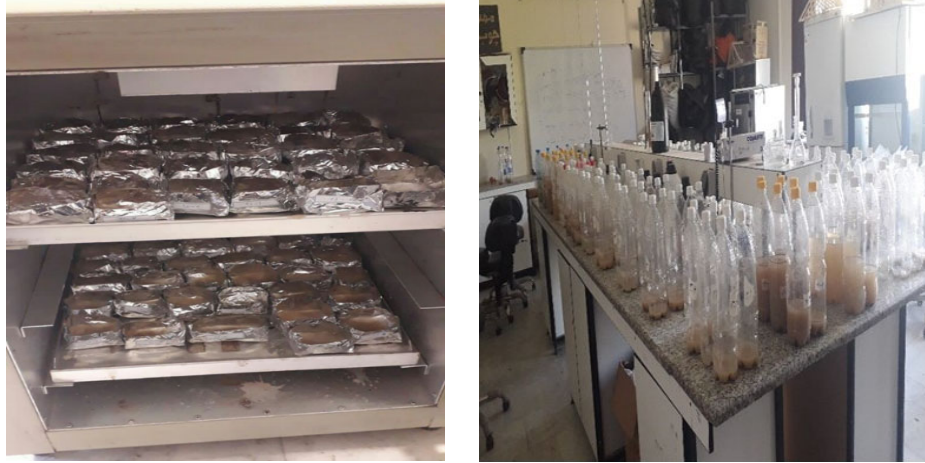
شکل ۴- نمایشی از ته‌نشینی (راست) و خشک نمودن رسوبات در کوره حرارتی (چپ) Fig. 4. A view of sedimentation (right) and drying of sediments in a thermal furnace (left)
